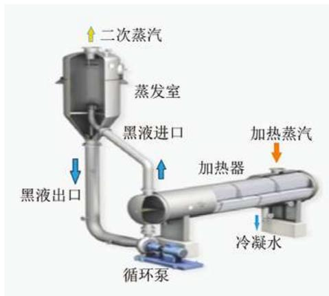
图10 强制循环蒸发器结构原理简图
