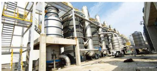
图6 B浆纸厂8效板式降膜蒸发系统现场照片
