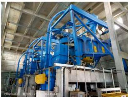
木片筛 (1000m<sup>3</sup>/h, 700m<sup>3</sup>/h) + 再碎机 (110m<sup>3</sup>/h)
