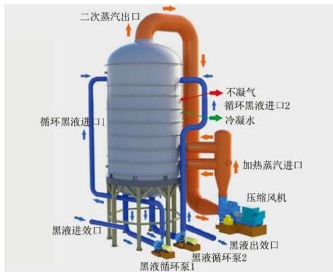
图7 MVR蒸发器结构原理简图
