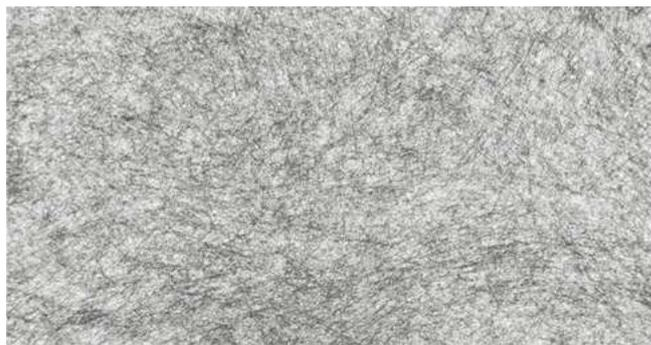
图6 使用超声设备分散碳纤维所抄造的碳纤维纸
