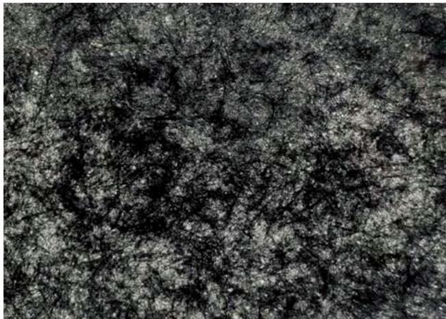
图5 未使用超声设备分散碳纤维所抄造的碳纤维纸
