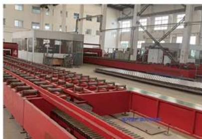
板片生产激光焊接机
