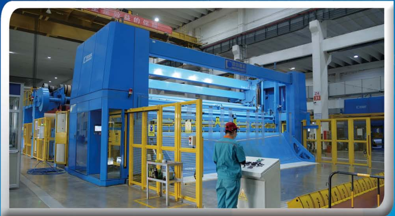
国内某纸厂7600mm/2800m/Min高速分切复卷机
