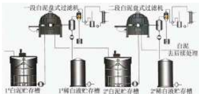
图7 盘式白泥洗涤机工艺流程
